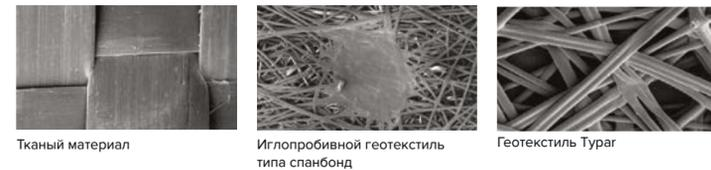
3. Гидрофильный и однородный по размеру сквозных отверстий материал обладает низким коэффициентом заиливания\*.
