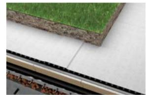
6. Приступайте к монтажу слоя озеленения, состоящего из растительного субстрата и финишного покрытия – рулонного газона. Допускается засеивание газона. «Зеленую» зону по периметру примыкания к ограждающим конструкциям отделите гравийной отсыпкой.
